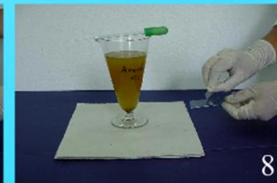
Lamínula sendo colocada sobre o material na lâmina
