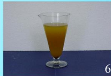
Calice contendo amostra filtrada em repouso para sedimentação
