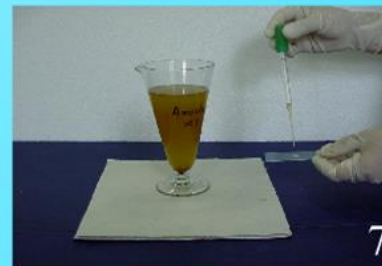
Pipeta colocando material retirado do fundo do cálice em lâmina
