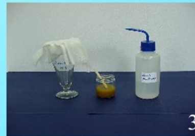
Amostra homogeneizada ao lado do cálice com gaze dobrada
