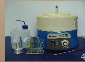
4 Amostra filtrada transferida para tubo de Wasserman e centrifugada
