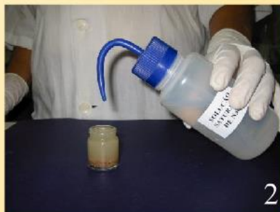
Homogeneização da amostra com solução de NaCl saturada
