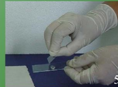
5 Lamínula sendo colocada sobre o material na lâmina
