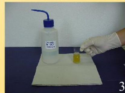
Lamínula em contato com camada superior do líquido
