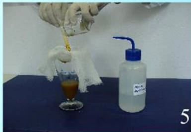
Amostra homogeneizada escorrida através do palito no cálice
