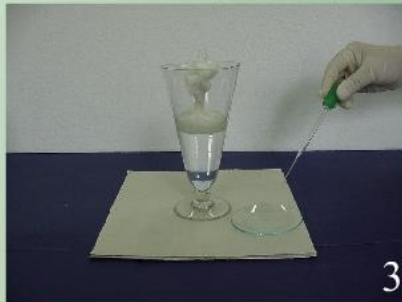
3 Coletor embocado no cálice de sedimentação até entrar em contato com a água
