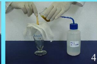
Amostra homogeneizada sendo escorrida através do palito no cálice
